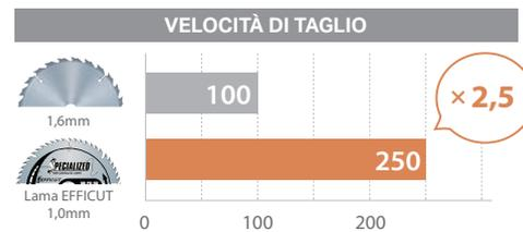
Le lame EFFICUT sono **2,5 volte più veloci** rispetto alle lame per sega standard. Il nuovo **design della punta** riduce il contatto con il materiale, aumenta l'efficienza del rilascio degli scarti e ha un angolo di smusso più acuto. Ciò significa che i tagli sono più efficienti e la batteria dura **2,4 volte di più** rispetto a una lama standard.
