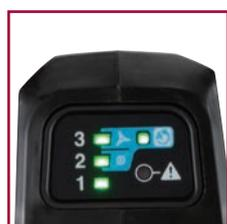
Regolazione funzionamento in base al tipo di lama
